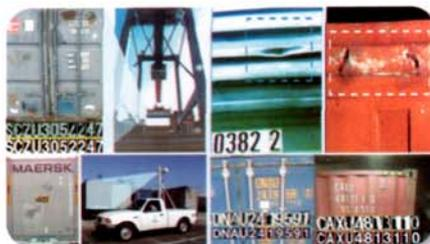
集裝箱號碼自動識別系統: 包括集裝箱自動定位、岸邊吊集裝箱自動定位及集裝箱破損檢測。
